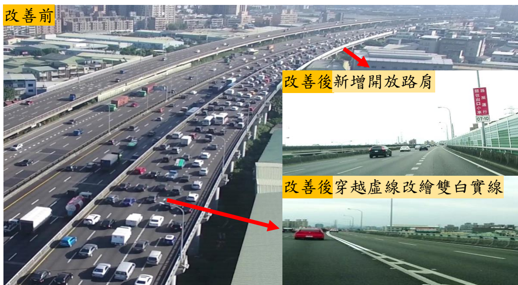
圖 11 國道 1 號五楊高架與五股轉接道匯流處改善前後對照圖
