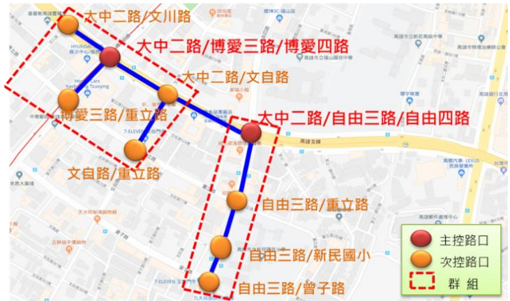
圖 7 國道 10 號鼎金系統自由路出口匝道整體控制系統示意圖
